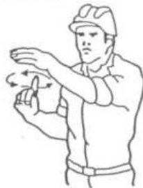
3 Levantar la carga lentamente
