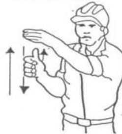
4 Levantar el aguilón o pluma lentamente
