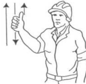
4 Levantar el aguilón o pluma lentamente
